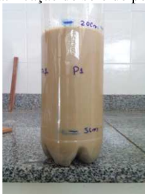
Figura 3: Estratificação do solo do ponto 1 de coleta
