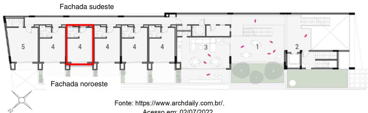
Foram simulados todos os dias do ano no intervalo das 7h30m às 17h30m, considerando uma malha de 0,30 m x 0,30 m, disposta num plano de trabalho a 0,75 m do piso de acordo com as recomendações da LM-83-12 (IES, 2012). No software TropLux 8 foi modelado um espaço a fim de identificar o potencial de aproveitamento da luz natural incidente para dentro dos ambientes, dessa maneira o banheiro dentro da modelagem foi descartado conforme Figura 6.
