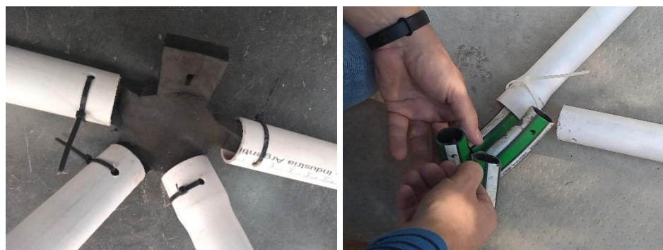
Figura 4: Nudos conectores flexibles
