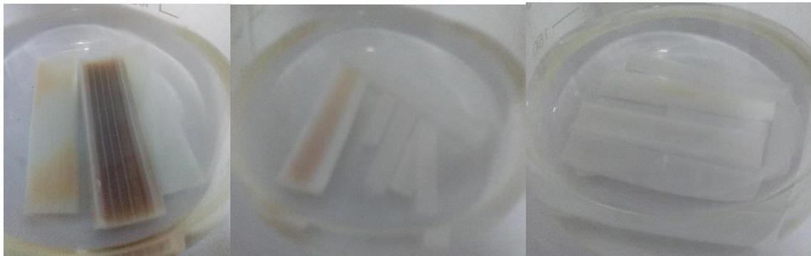
Descripción: a) conjunto C1 se observa completa decoloración para la madera balsa (der), parcial para la caña laminada (izq) y deficiente para la caña entera (centro). b) esta muestra C2 solo con pretratamiento alcalino se distingue una deficiente decoloración para la caña entera (izq) y completa para los otros bloques. c) en este conjunto C3 se aprecia una completa decoloración en todas las muestras.
