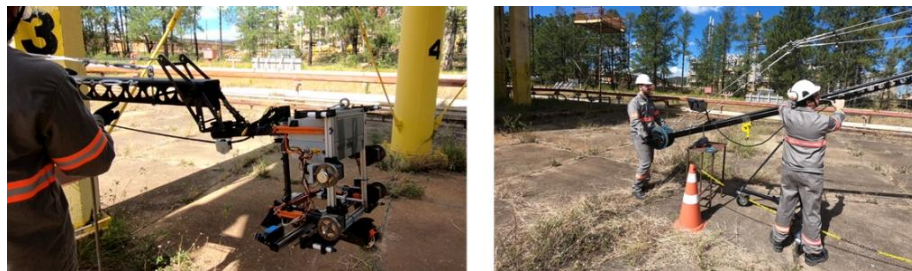
Figura 8 – Minigrua para transporte do Crawler .
