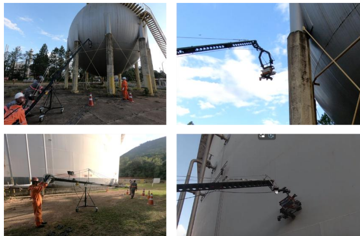
Figura 11 – Testes da minigrua no tanque esférico e cilíndrico.
