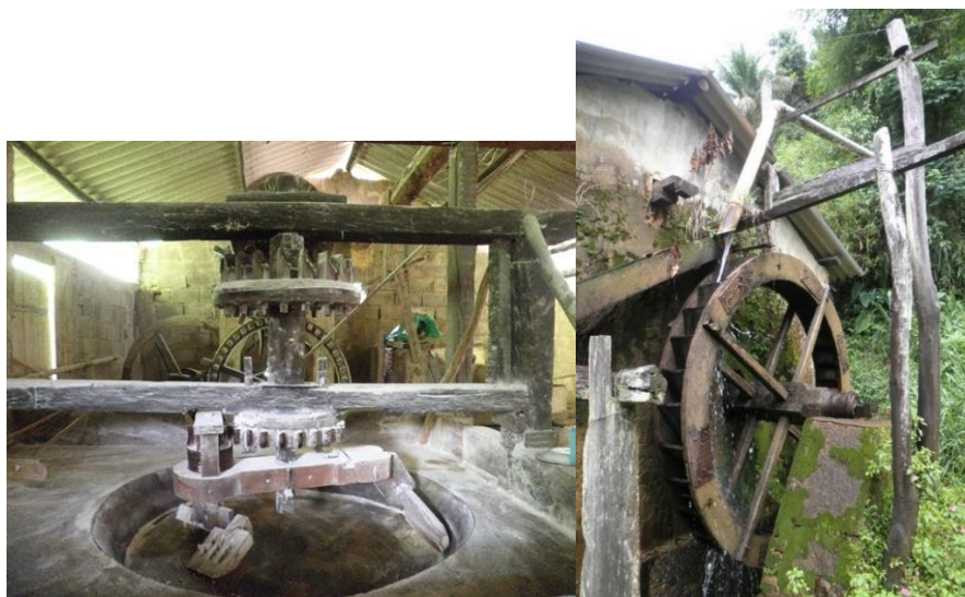
Figura 1. Método tradicional de preparo da farinha de mandioca na comunidade rural de Faraó, Cachoeiras de Macacu. A estrutura de madeira funciona através de uma roda d'água. (Fonte: Autor, 2013)
