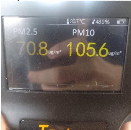
Figura 4. Equipamento de medição de partículas PM2.5 e PM10, concedida pelo Coletivo Martha Trindade.
