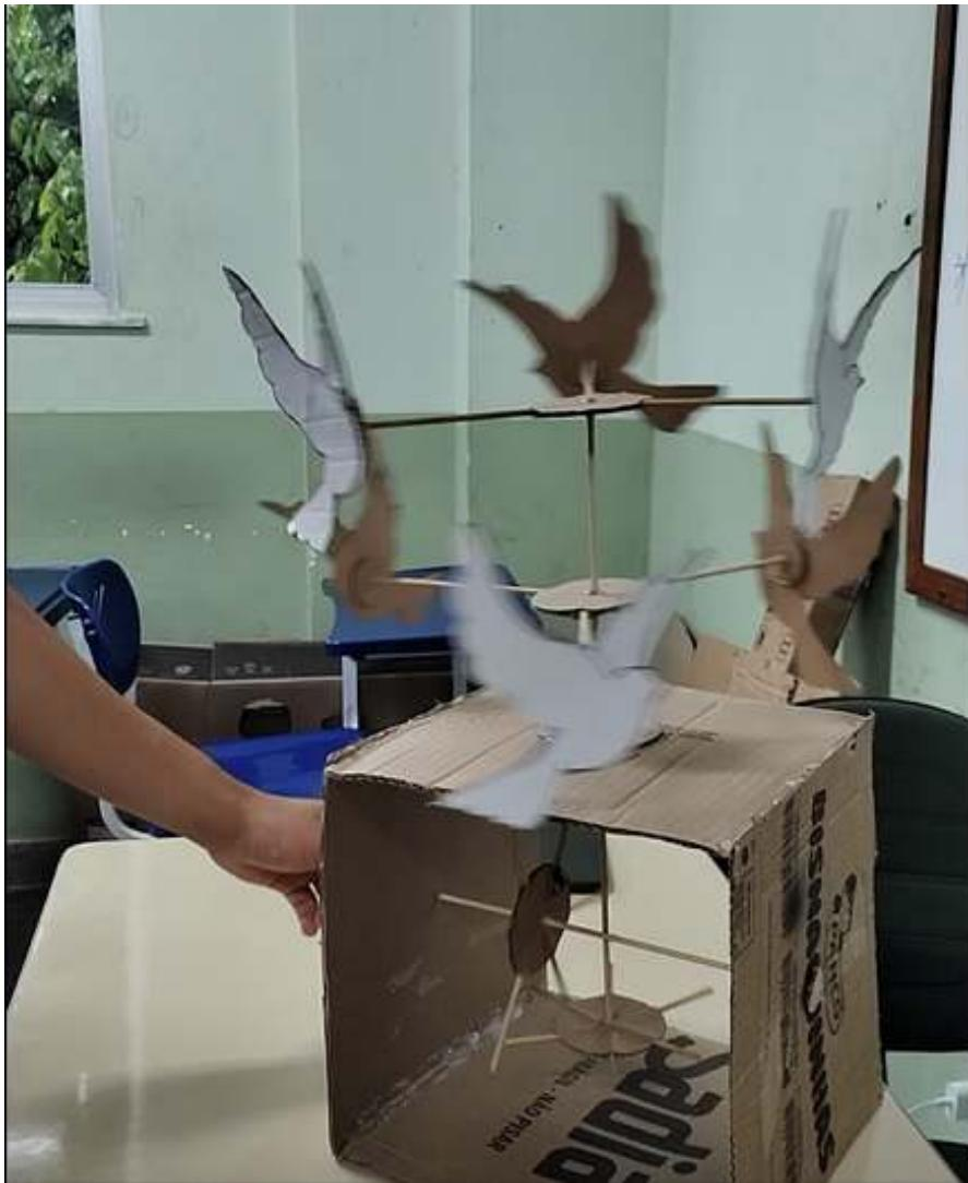
**Figura 7:** Mecanismo que movimenta pássaros mediante interação com o público, objeto produzido pelo 2º ano do curso de Ensino Médio Integrado ao Técnico em Eletromecânica, em 2023. Fonte: Arquivo pessoal.
